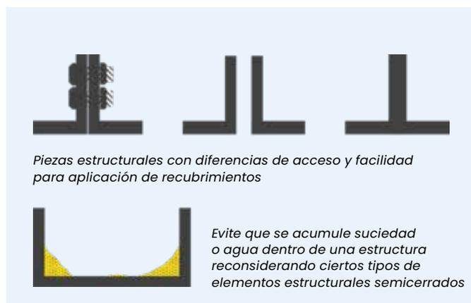
La corrosión en elementos tipo caja y los componentes huecos que estén adecuadamente sellados del ambiente externo será insignificante. Es otro ejemplo de diseño que puede ser necesario considerar para ser pintado si no se puede evitar la entrada de humedad.
