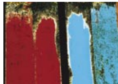
Transocean evalúa todos los Anti-incrustantes en sus paneles de prueba. Arriba se muestra un ejemplo de 2 paneles.
